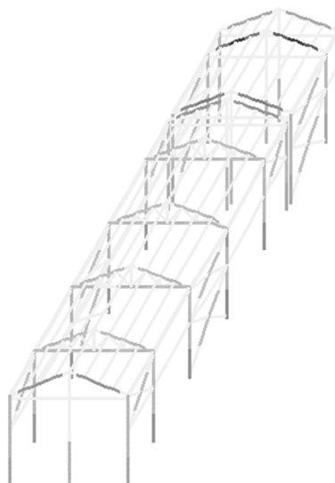
Рис. 5. Напряжения в элементах от собственного веса металлокаркаса при осадке фундамента (ЛИРА-САПР)
